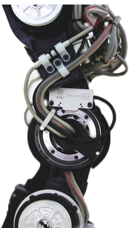
AksIM™ アブソリュートロータリーエンコーダを搭載した REEM-C の膝関節
