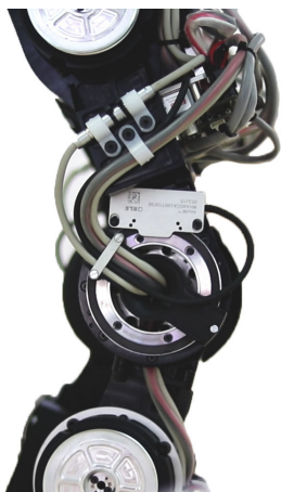
REEM-C Kniegelenk mit Absolut-Winkelmesssystem AksIM™
