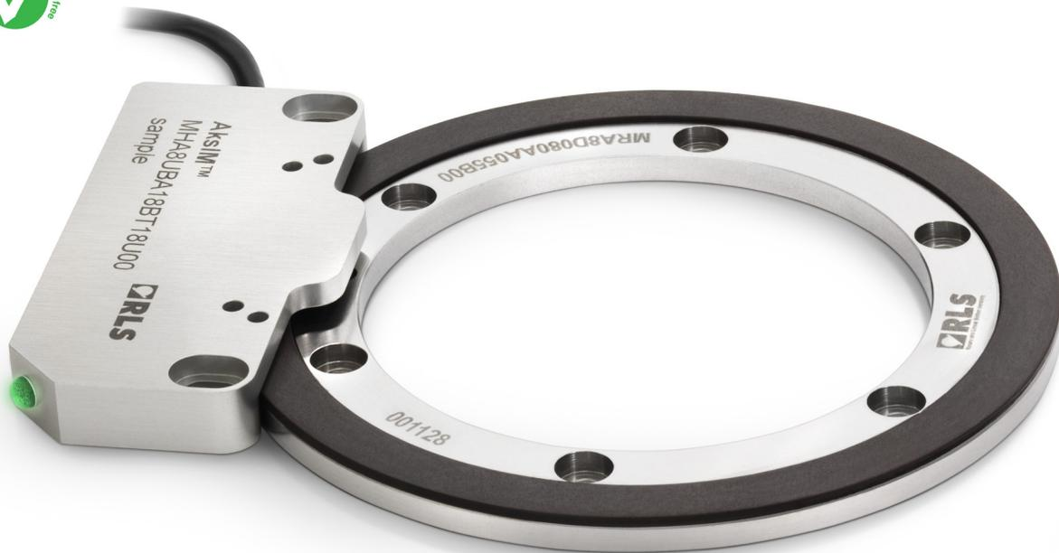
**AksIM™ ist ein berührungsloser, leistungsstarker absoluter off-axis Drehgeber für Anwendungen mit begrenzten Platzverhältnissen. Durch den Hohlring, die absolute Funktionsweise und die hohen Betriebsgeschwindigkeiten eignet sich dieses Messsystem für verschiedenste Anwendungen.**
