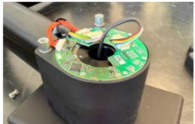
Touch 测量臂关节中的 AksIM 编码器
